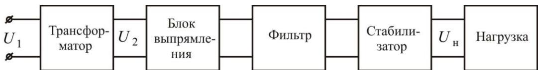
**Рис. 1.1** Структурная схема источника питания
