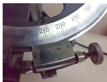
Рис. 5 – Пример кругового нониуса
