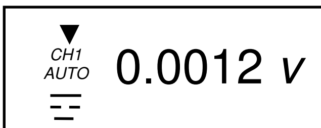
Рис. 8. Пример информации на индикаторе цифрового прибора в режиме измерения постоянного тока в вольтах (V):
