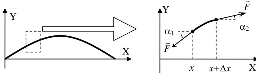
ны  $L$  и массы  $m$ , закрепленной с обоих концов. Пусть сила натяжения струны  $F$  постоянная по величине. Форма струны задается уравнением  $y(x)$ . Выделим малый кусок струны, длина которого вдоль оси  $X$  равна  $\Delta x$ , а масса  $\Delta m$ . Так как колебания поперечные, то запишем второй закон Ньютона для куска  $\Delta m$  вдоль оси  $Y$ :  $\Delta m a_y = F \cdot \sin \alpha_2 - F \cdot \sin \alpha_1$
