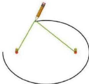
Литотрипсия— один из методов дистанционного разрушения камней с помощью ударных волн. Принцип работы многих аппаратов дистанционного воздействия основан на геометрических свойствах эллипса.
